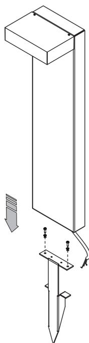
Per collegare l'apparecchio è necessario usare un connettore IP67
